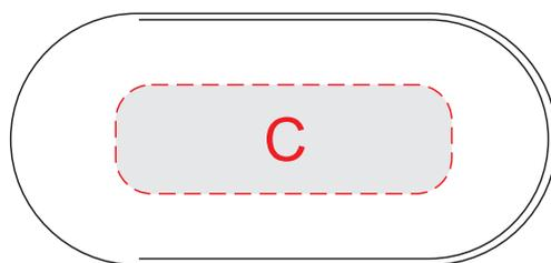
Внимание! При нанесении тиснения точное позиционирование невозможно (нанесение может «гулять» в пределах 2-3 мм)
