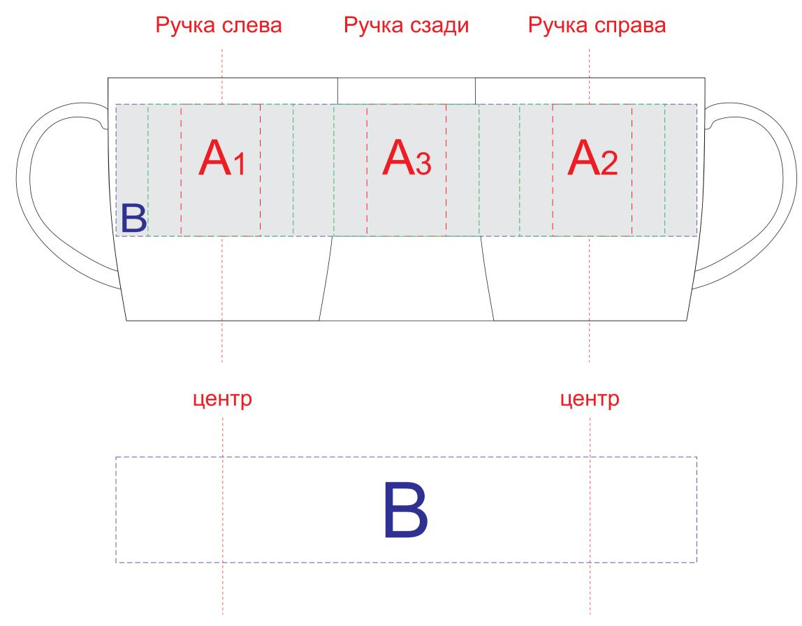
Внимание! При круговой гравировке с шириной логотипа более 55 мм центрирование логотипа должно быть относительно середины зоны нанесения А2 (положение - ручка сзади)
