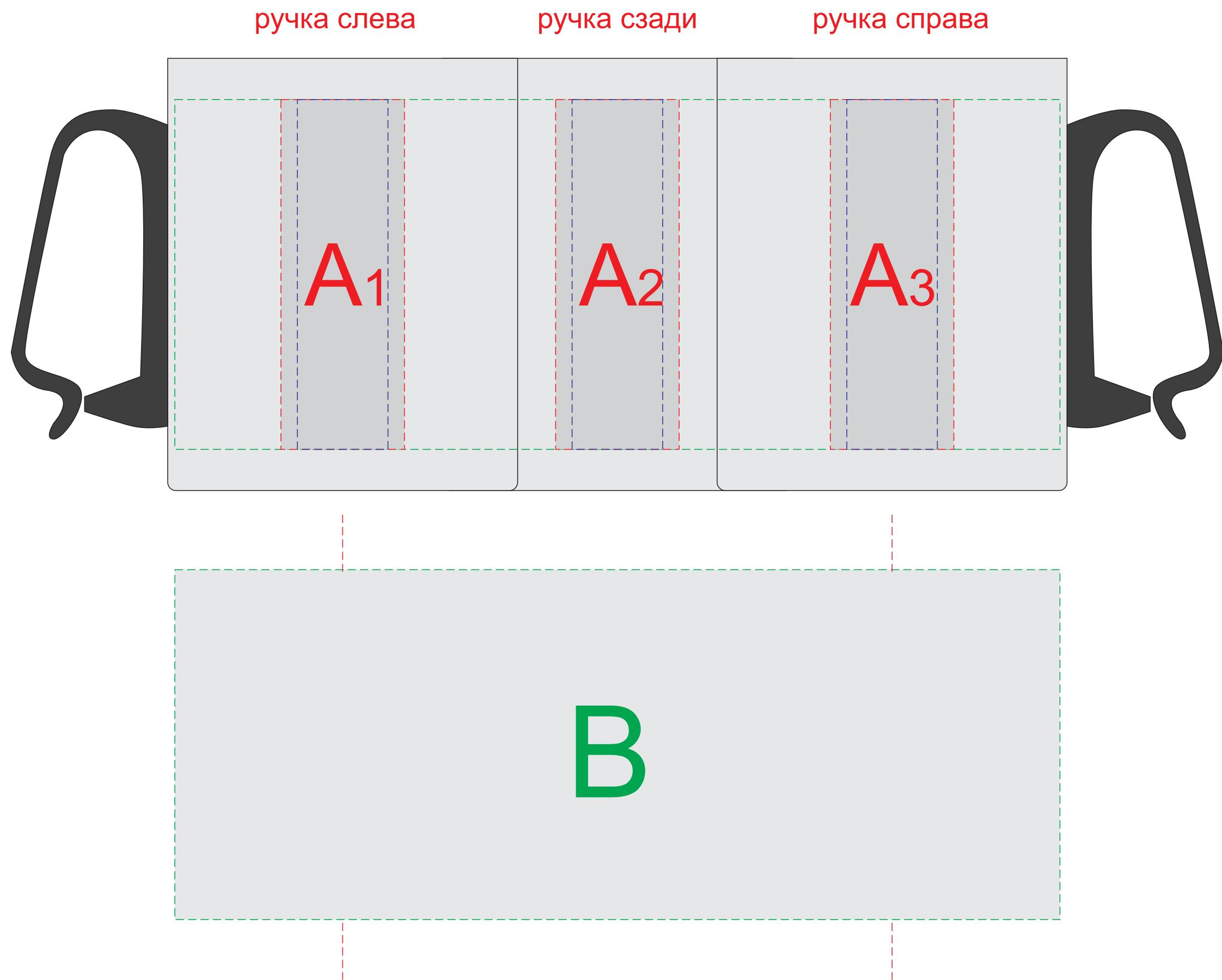
Внимание! При круговой гравировке с шириной логотипа более 56 мм центрирование логотипа должно быть относительно середины зоны нанесения A2 (положение - ручка сзади)
