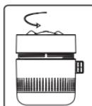
Поверните против часовой стрелки и снимите верхнюю крышку
